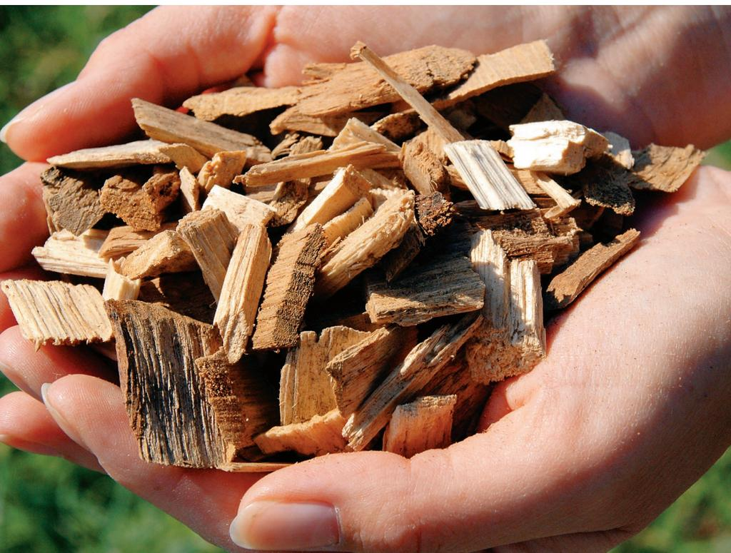
Qualischnitzel sind ausgesiebte, auf maximal 16% Restfeuchte getrocknete Holzchnitzel aus den Wäldern der Region. Sie werden auf eine Grösse von 5 bis 30 mm und eine Dicke von 4 mm kalibriert und eignen sich für Trockenschnitzelfeuerungen ab 15 bis 500 kW Leistung. Qualischnitzel bestehen zu 90% aus Laubholz und haben damit einen hohen Energiewert bei gleichzeitig geringem Ascheanfall. Qualischnitzel brauchen wenig graue Energie und werden maximal 40 Kilometer weit gefahren.
